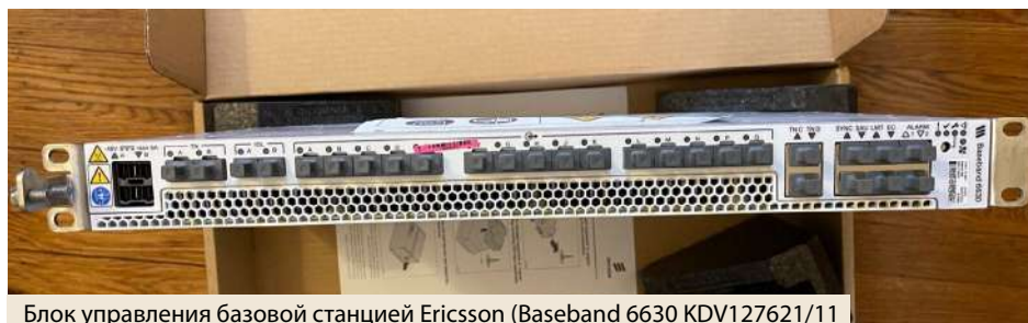
Блок управления базовой станцией Ericsson (Baseband 6630 KDV127621/11)
